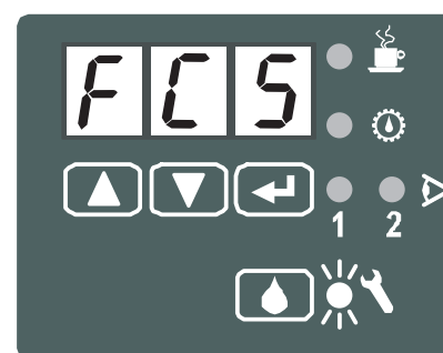
Figura 34 Notificación de fallo en la pantalla del dispositivo visualización
